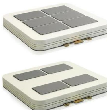
Mynd 4: IGBT – háspennu íhlutur (presspack frá ABB)
